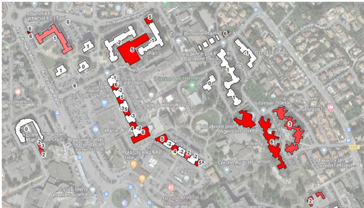
Vitrolles – croisement entre les hauteurs maximales et les hauteurs des bâtis pour estimation bâtiments surélevables
